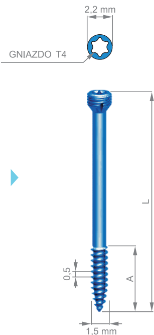
WKREĆ KOMPRESYJNY COMPRESSION SCREW
